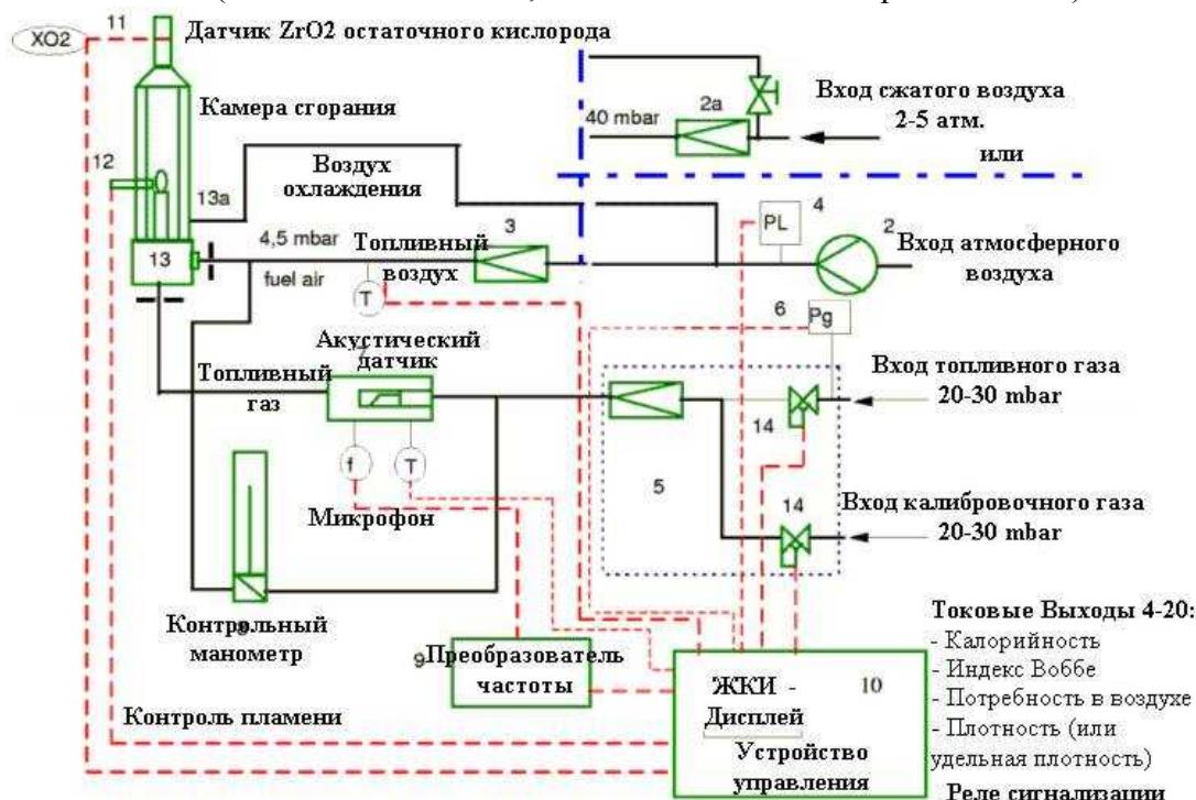
Сигналы, полученные после измерения, направляются для обработки в электронный блок управления и измерения, в котором происходит расчет свойств горючего газа, после обработки данные выдаются через гальванически развязанные аналоговые выходы 4-20 мА для каждого параметра и могут использоваться в системе регулирования или обрабатываться вычислителем.
